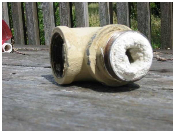
*Imagen 3. Depósito de estruvita en un codo.*
