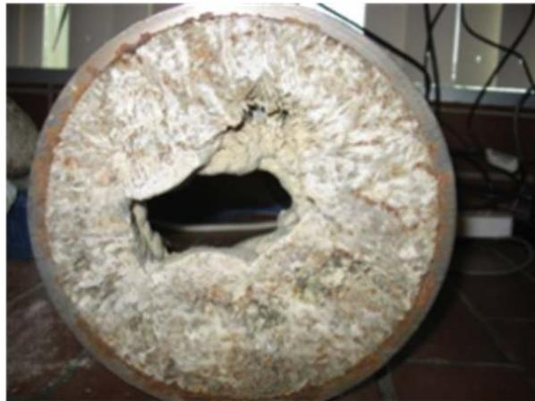
*Imagen 2. Depósito de estruvita en una tubería.*
