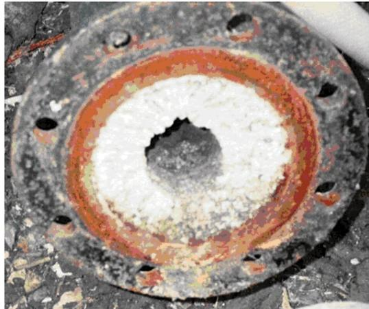
*Imagen 1. Depósito de estruvita en una tubería.*
