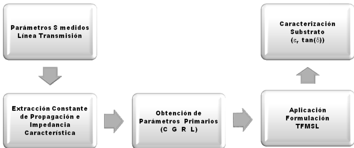
Fig.5. Algoritmo del método utilizado para obtener las propiedades dieléctricas del sustrato.
