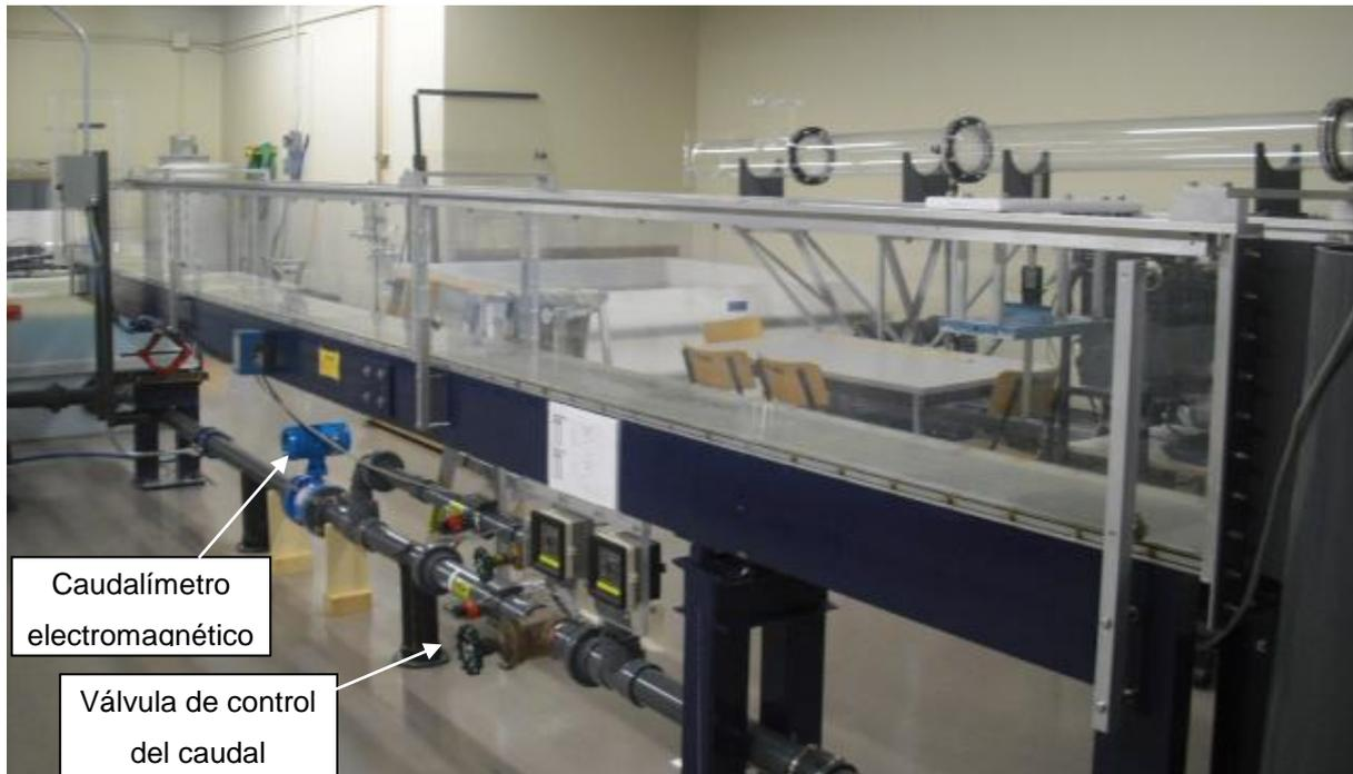
Figura 3.1 Elementos del canal de laboratorio
