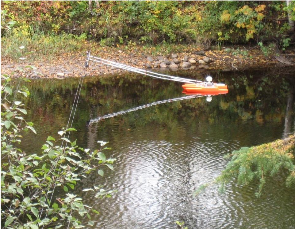
Figura 4.5 ADCP sobre flotador en funcionamiento (Hydro-Quebec)
