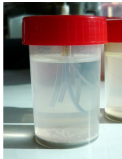
Figura 3.43 - Fibras P-C en disolución saturada de cemento Pórtland.
