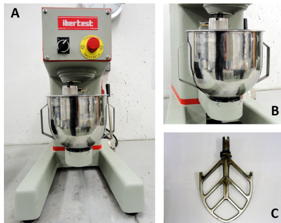
Figura 3.25 - Equipo de amasado A – Amasadora; B – Recipiente de 5 l; C – Pala
