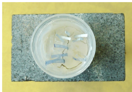
Figura 3.44 – Fibras P-C en pasta de hidróxido cálcico.
