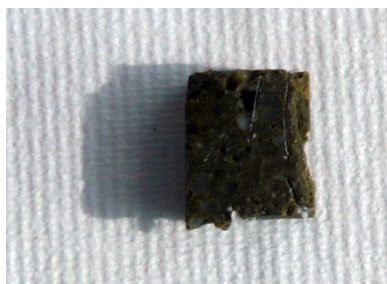
Figura 3.50 - Muestras cortadas con sierra circular de sobre-mesa
