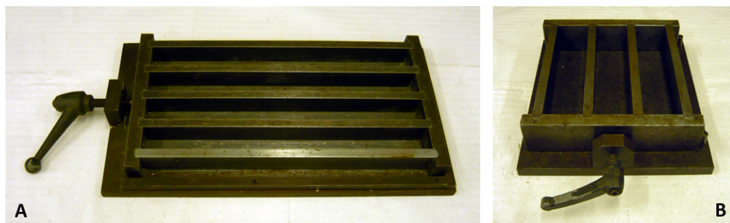
Figura 3.20 - Moldes metálicos para muestras prismáticas. A – 25 \times 25 \times 287 \text{ mm}^3 ; B – 40 \times 40 \times 160 \text{ mm}^3
