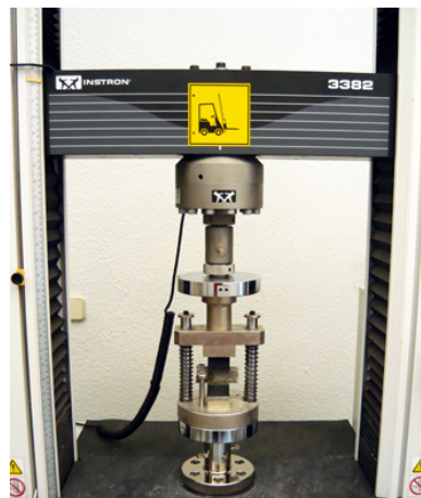
Figura 3.33 - Prensa Instron 3382 (Bastidor equipado con accesorios para ensayo a compresión)
