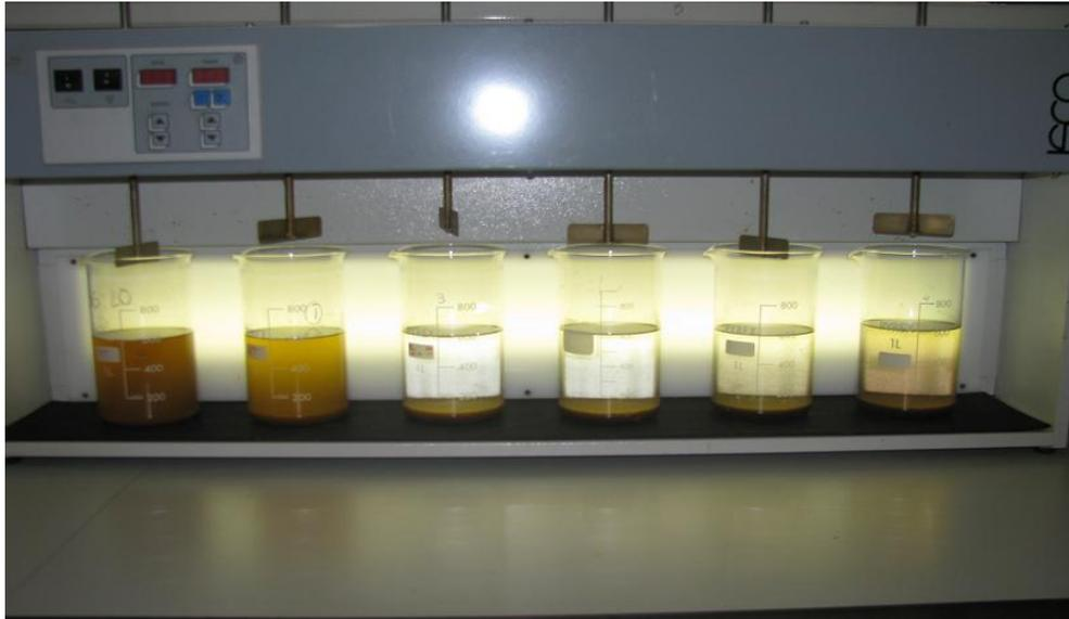
Figura 14. Prueba “jar-test” a diferentes pH de tratamiento con 0,5 ml/L de  $\text{FeCl}_3$  en todos los vasos (de derecha a izquierda pH de: 9,01, 8,22, 7,02, 6,1, 4,94 y 4,32).
