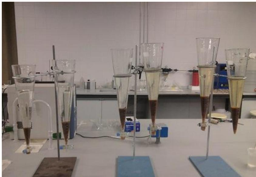
Figura 11. Resultado del tratamiento con FeCl<sub>3</sub> y Quifloc para diferentes concentraciones de FeCl<sub>3</sub> (de izquierda a derecha la concentración va incrementándose).
