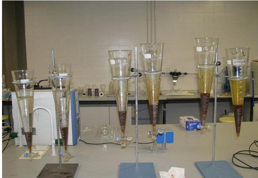
Figura 10. Resultado del tratamiento con  $FeCl_3$  y Ecol para diferentes concentraciones de  $FeCl_3$  (de izquierda a derecha la concentración va incrementándose).
