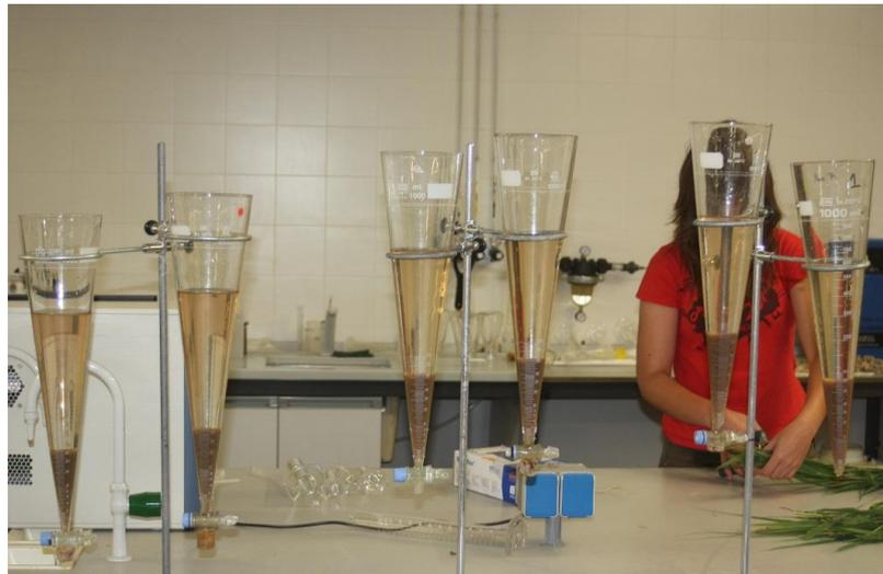
Figura 13. Resultado del tratamiento con Ecomix y Quifloc para diferentes concentraciones de Ecomix (de izquierda a derecha la concentración va incrementándose).
