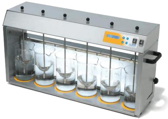
Figura 8. Equipo "jar-test".
