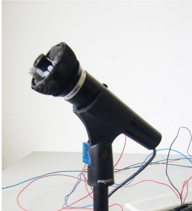
Imagen 25. Prototipo experimental de micrófono con el sistema de detección de vídeo integrado en la alcachofa. Colocando la otra mitad de la esfera de la alcachofa se disimula el mecanismo.
