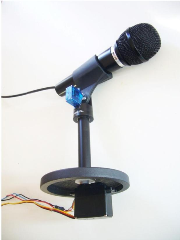
Imagen 21. El servomotor de la base, responsable del movimiento horizontal del pie de micrófono, y el que articula la pinza del micrófono y con ello el movimiento en el plano vertical.
