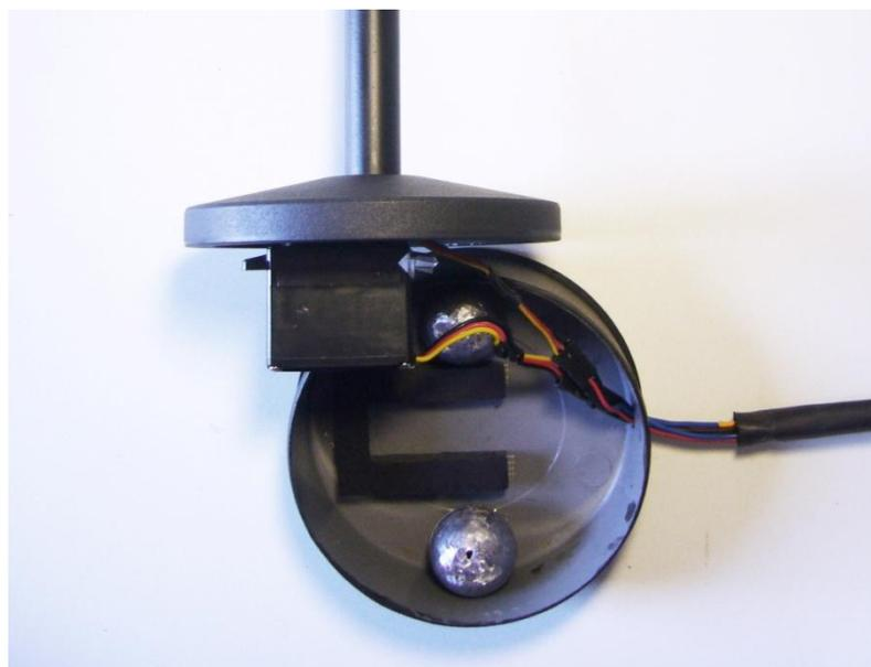
Imagen 22. Recubrimiento y protección de los cables con aislante térmico. Añadido de peso a la base con bolas de plomo y estructura para fijar el servomotor a la base.
