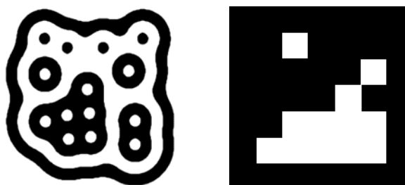
Figura 14: Ejemplos de marcas para realidad aumentada: (Izquierda) Fiducial y (derecha) patrón de contraste.
