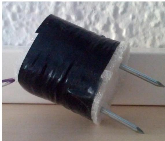
FOTO 6.9: SENSOR RESISTIVO DE HUMEDAD DEL SUELO
