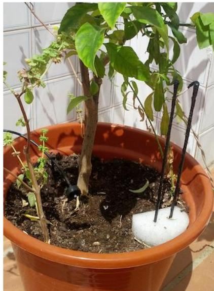
FOTO 7.5: INSTALACIÓN DEL SENSOR DE HUMEDAD DEL SUELO
