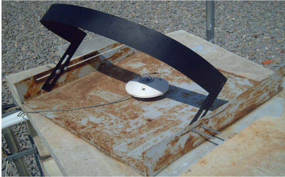
Figura 4.10. Detalle de la banda de sombra sobre el piránometro CM 11.
