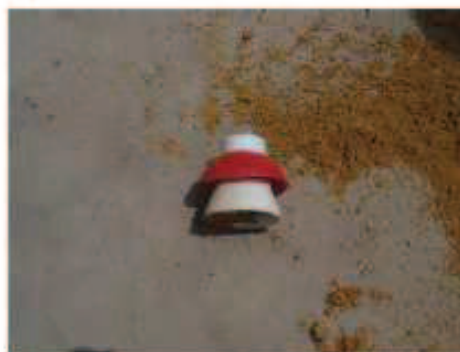
Fotografía 23: Detalle del estado de una de las protecciones que quedó en el interior del saco. No hay perforación de la armadura de acero a través de la pieza plástica.
