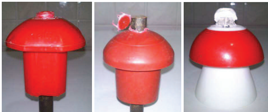
Figura 4.6: Imágenes de setas después de la rotura.
