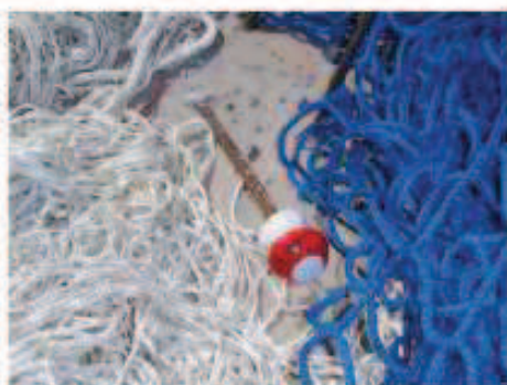
Fotografía 6: Detalle del estado final de una de las protecciones tras sufrir el impacto
