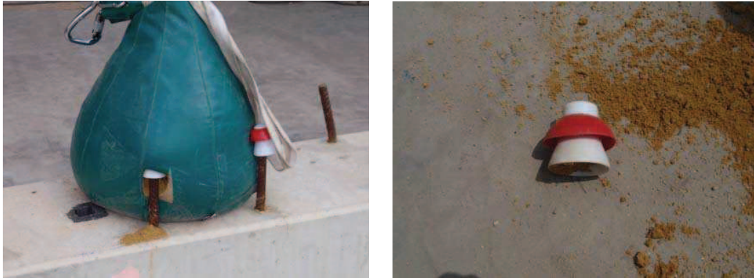
Figura 4.6: Impacto cuerpo blando desde 4m. Estado del protector después del impacto.
