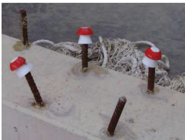
Figura 4.5: Impacto cuerpo rígido desde 1m. Los protectores resisten.
