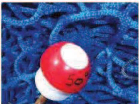
Fotografía 7: Ejemplo protección en buen estado tras el impacto
