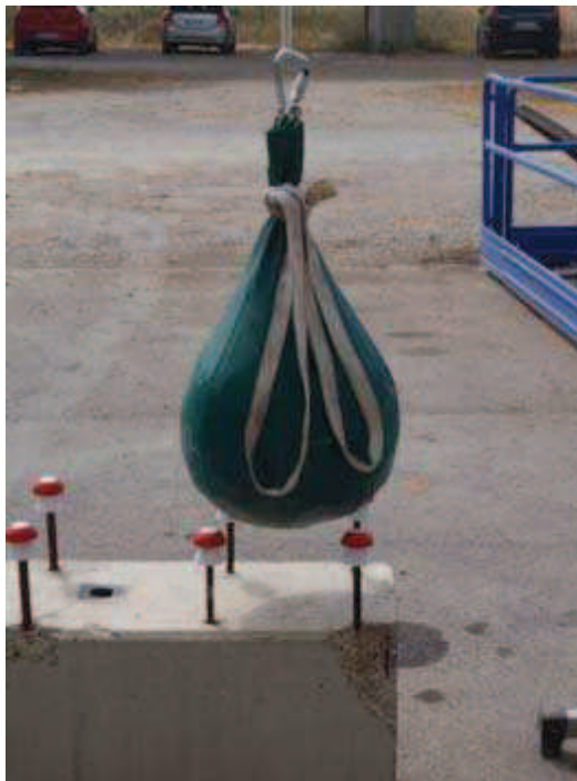
Figura 3.13: Preparación de impacto con cuerpo blando.
