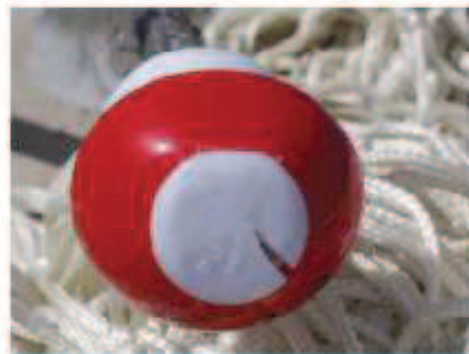
Fotografía 9: Detalle de las fisuras parciales apreciadas en una de las protecciones tras impacto.
