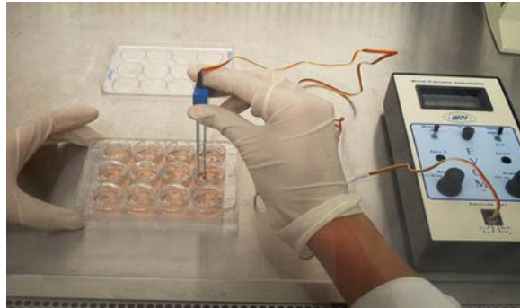
Figura 4. Medición de la resistencia eléctrica transepitelial de monocapas en sistemas Transwells ® empleando un voltímetro Millicell ® -ERS.
