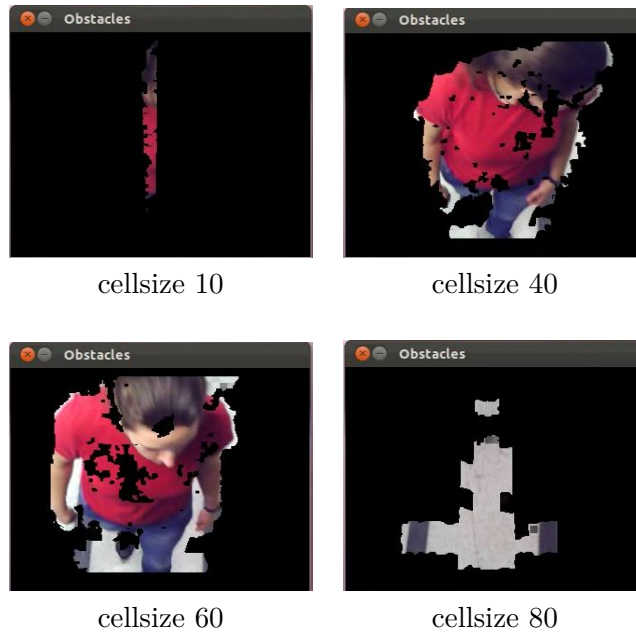
Figura 69: Detección de obstáculos: variación del tamaño de celda
