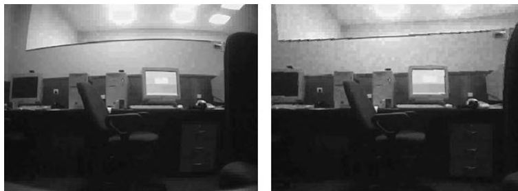
Figura 34: Imagen distorsionada (izquierda) y corregida (figura de [47])
