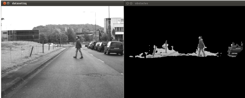
Figura 75: Detección de obstáculos verticales tras filtrado y ajuste de parámetros
