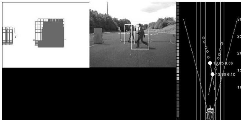
Figura 26: Detección y tracking en el sistema protector para la evaluación de riesgos, figura de [12].
