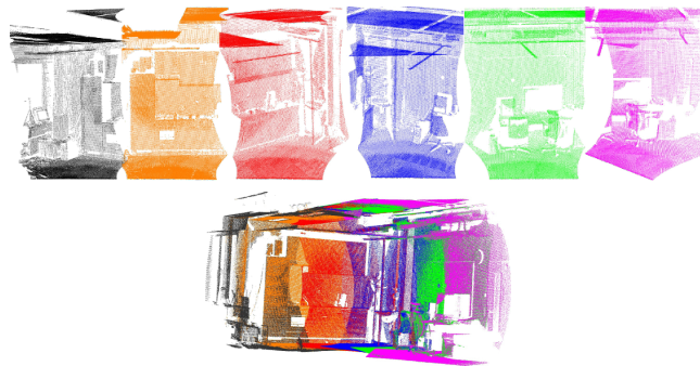
Figura 42: Combinar nubes de puntos en un solo modelo, mediante PCL
