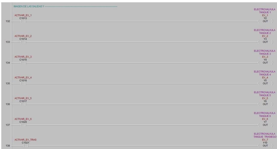
Como ya sabemos, cada marca de activación de una electroválvula debe activar una salida en el autómata para que eléctricamente se realice la acción correspondiente. Las salidas Y2, Y3, Y4, Y5, Y6, Y7 e Y10 se encuentran convenientemente cableadas a cada electroválvula.
