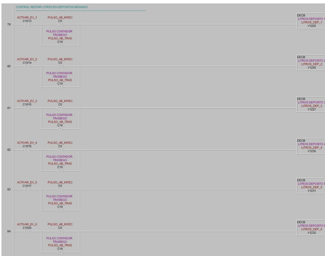
Tanto si el pulso es hacia el depósito de trasiego (C16), como si es inyectado a la red directamente desde uno de los 6 depósitos (C5, recordemos, pulso de inyección abono en red), habrá que restar un litro convenientemente en el depósito correspondiente. Esto se realiza con la orden DECB sobre la dirección de memoria elegida. Las marcas C1013, C1014, C1015, C1016, C1017 y C1020, indican que tanque tiene su electroválvula de salida abierta.
