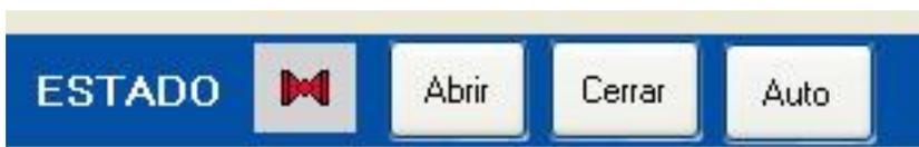
Justo al lado del desplegable de la red, podemos ver el estado actual del cabezal. La imagen de la válvula muestra este estado mediante un código de colores descrito al pie de página. Mediante los botones situados a la derecha del indicador, podemos cambiar este estado con tres posibilidades:
