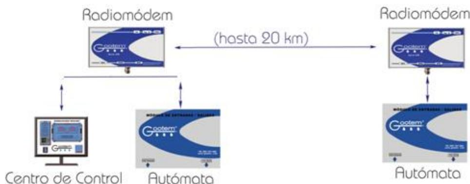
**Ilustración 12: Elementos de telecontrol de los cabezales 3 y 4**
