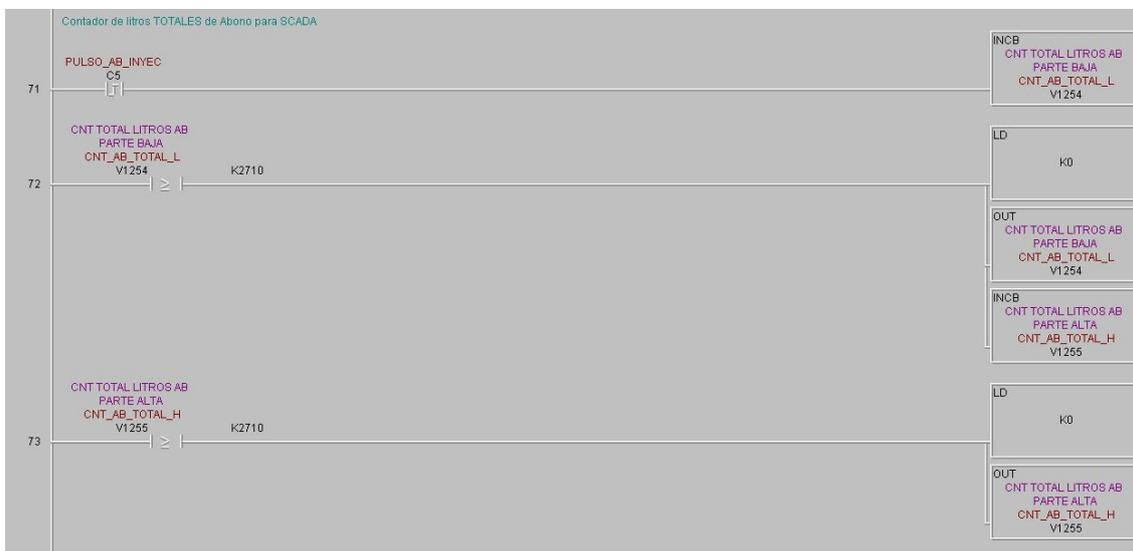
Para la visualización en el SCADA de un contador total de litros de abono inyectados en la red, como antes, dividimos el contador en dos: parte baja y parte alta, ambas de cuatro dígitos, quedando almacenada la parte baja en la posición de memoria V1254 y la alta en la V1255.
