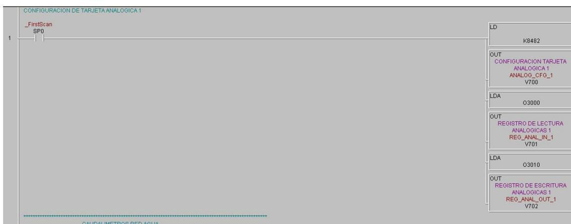
En primer lugar, configuramos la expansión añadida al PLC como una tarjeta analógica de 4 entradas y 2 salidas, todas ellas correspondientes a corrientes de entre 4 a 20 mA; a su vez configuro las posiciones de memoria del PLC en las que almacenaré los valores de dichas entradas y salidas, quedando que las entradas analógicas y sus posiciones de memoria serán:
