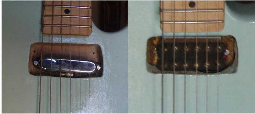
**Ilustración 15:** A la izquierda un detalle de la posición de la pastilla<sup>0</sup> en G1, a la derecha la pastilla<sup>2</sup> sin la cubierta, en G3.
