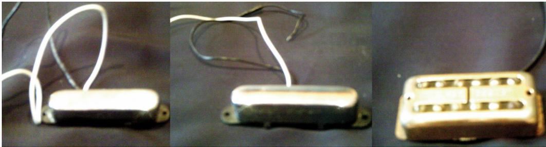
**Ilustración 7:** De izquierda a derecha, la pastilla simple de material cerámico, la pastillas simple de Alnico V, y la pastilla doble de material cerámico
