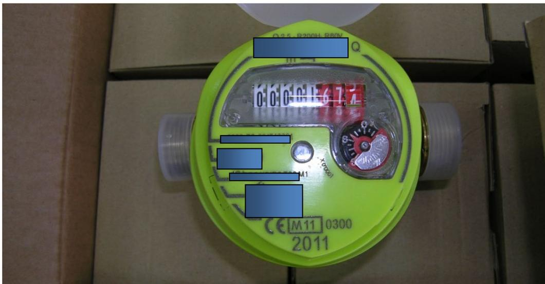
11. El error del contador se calcula a partir del volumen acumulado por el tanque volumétrico y las dos lecturas del contador, antes y después de la prueba. El caudal asociado a dicho error se obtiene dividiendo el volumen acumulado entre el tiempo registrado por el cronómetro.
