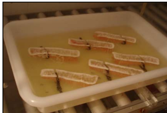
FIGURA 2. Cilindros introducidos en la salmuera saturada.
