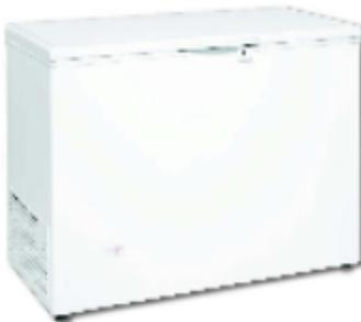
Puertas ciegas abatibles. Exterior en chapa acero plastificada blanca atóxica, con tratamiento anticorrosivo y cámara en aluminio. Aislamiento en poliuretano inyectado sin CFC. Mueble con ruedas. Evaporador estático. Condensador ventilado. Cuadro de mandos: termostato, termómetro
