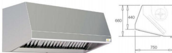
La campana integra un ventilador centrífugo de baja presión, construido en acero, con motores cerrados monofásicos de condensador permanente 230V 50Hz y dispositivo de protección térmica con rearme automático.
