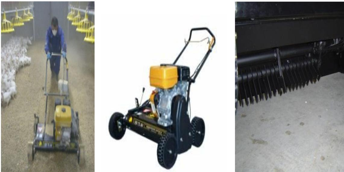
**FIGURA 1.** Máquina utilizada para realizar la técnica del volteo de la cama y detalle de las cuchillas metálicas.
