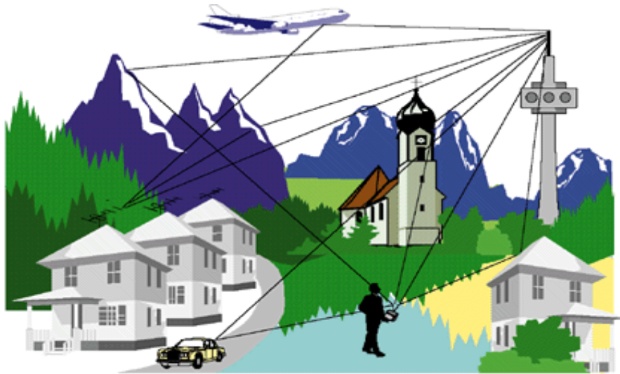
Figura 6. Efecto multitrayecto en redes de radiodifusión
