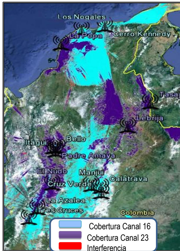
Figura 2 .Planificación de la red de DVB-T a dos frecuencias por RTVC
