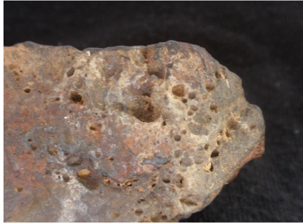
Fig. 2.21. Detalle de la escoria, donde se puede observar los agujeros -algunos con depósitos- y la capa grisácea-marronazo.
