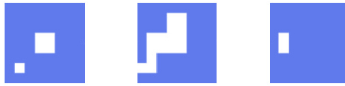
Fig.14 Ejemplo de proceso de dilatación y posterior erosión utilizando una cruz como elemento estructurante.
