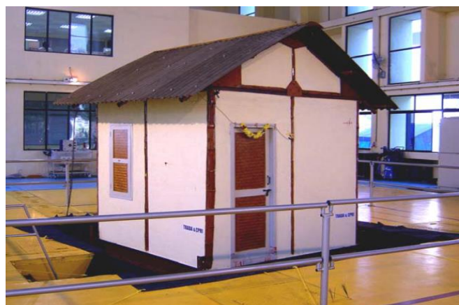
Figura 9. Sistema de viviendas de bambú desarrollado por TRADA - IPIRTI. Montaje sobre la mesa vibratoria de seis grados de libertad
