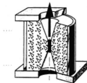
Figura 2.27. Ensayo propuesto por Noghabai (1995) [72]
