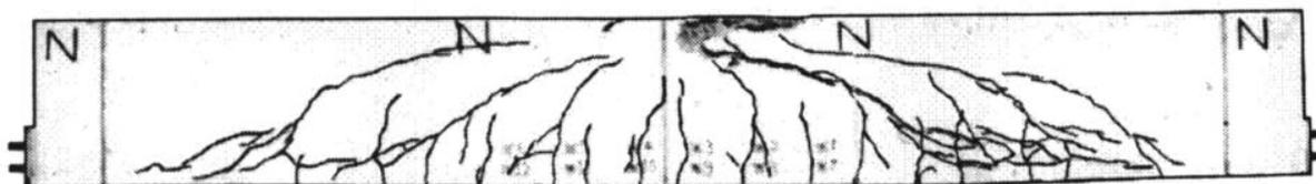
Figura 7.17. Distribución de fisuras en la viga A1 para carga última [97]
