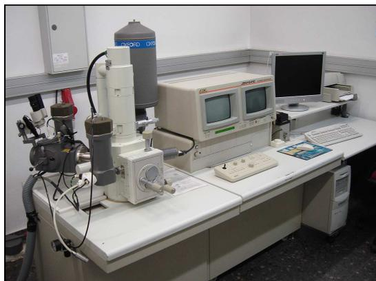
**Figura 3.7** Microscopio electrónico JEOL JSM-5410 SCANNING MICROSCOPE de la UPV
