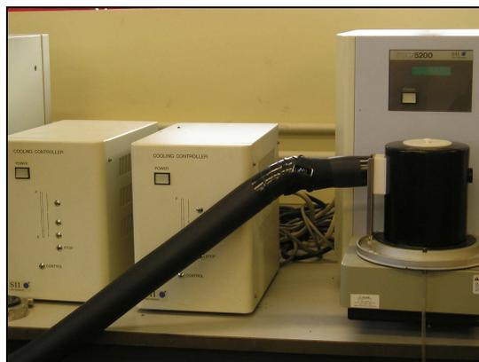
**Figura 3.6** Cámara hermética del equipo DSC
