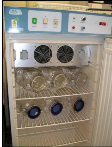
**Figura 3.11** Cámara a temperatura controlada conteniendo recipientes para la determinación de la isoterma de adsorción de agua
