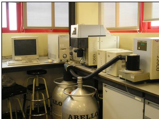
**Figura 3.5** Calorímetro Diferencial de Barrido DSC5200CO de Seiko Instruments
