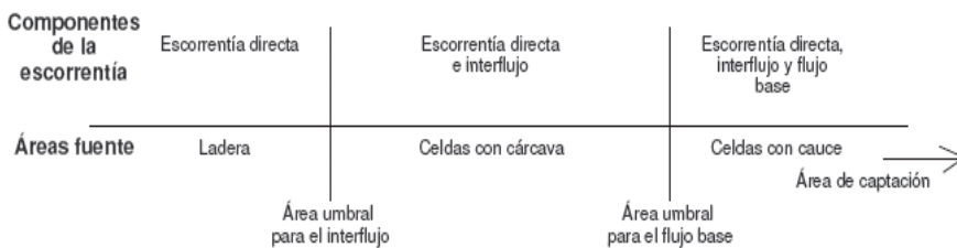
Figura AII.3. Elementos del sistema, áreas umbrales y componentes de la escorrentía (tomado de Montoya, 2008).
