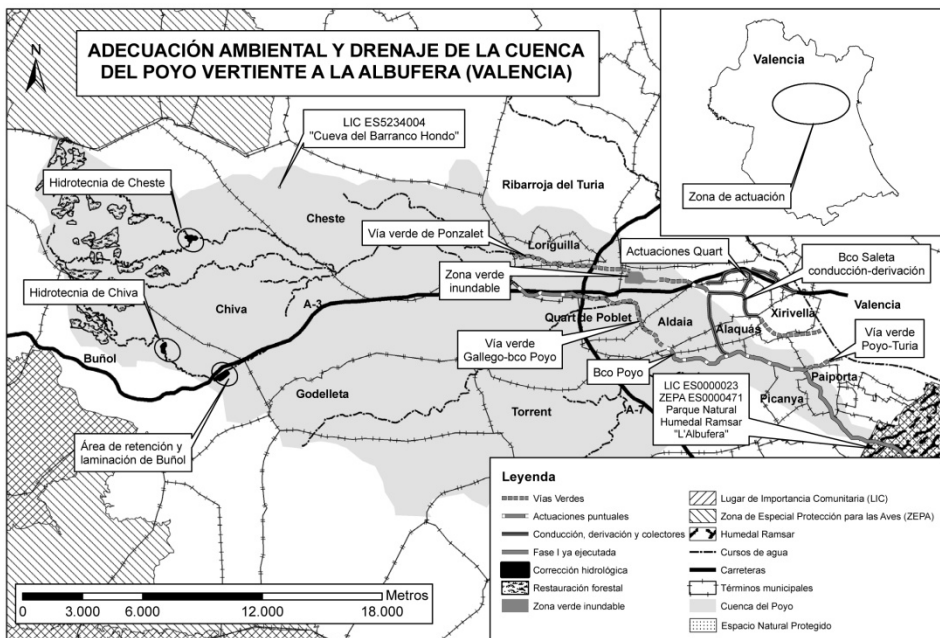
Figura 5-1. Actuaciones previstas en el Proyecto de “Adecuación ambiental y drenaje de la cuenca del Poyo vertiente a la Albufera, Valencia” (Ministerio de Medio Ambiente, y Medio Rural y Marino, 2012)
