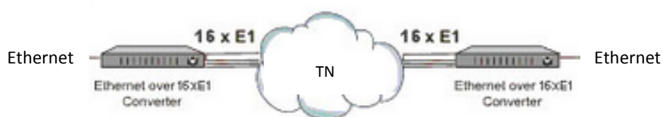
Figura 76: Esquema de Mini - Link TN Ericsson con mapeo de Ethernet sobre 16 flujos E1. La capacidad virtual es 32Mbps.
