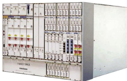
Figura 25: Vista de un Multiplexor SDH: SMX de Alcatel-Lucent
