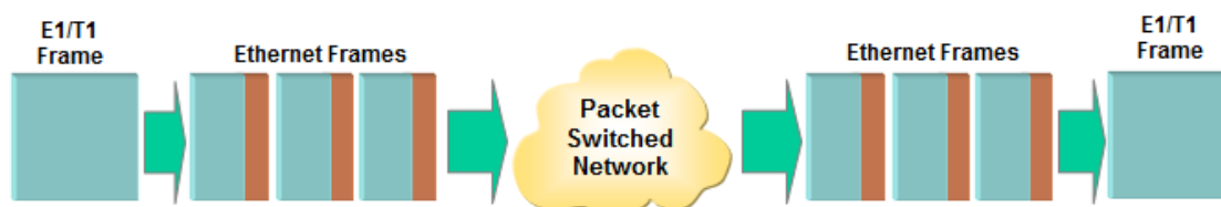
Figura 46: Proceso de segmentación en paquetes de un flujo de tráfico TDM, que se produce en un Circuit Emulation Service (CES) [24]
