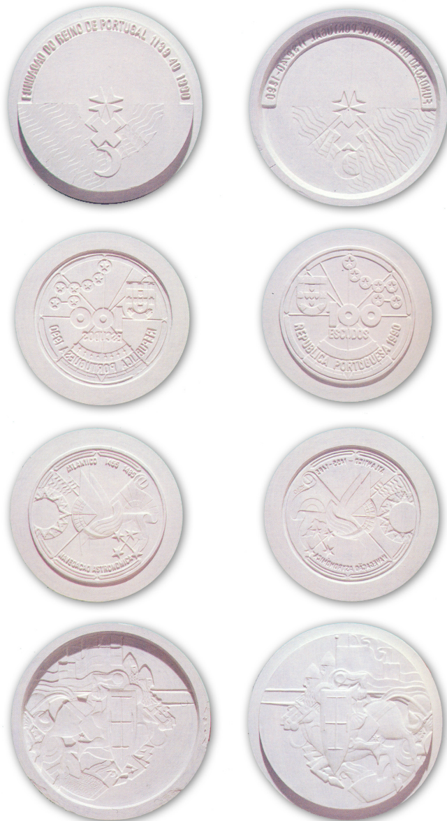
Figura 125. Conjunto de matrizes de moedas em gesso
