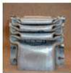
Figura 6. Deformación de un soporte fabricado con TWIP. Fuente: Arcelor.
