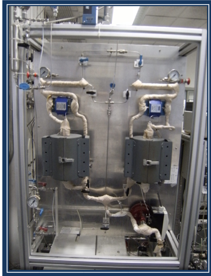
Figura 11. Foto del reactor empleado para el reformado de bioetanol. Reactor RIR 2(ITQ)
