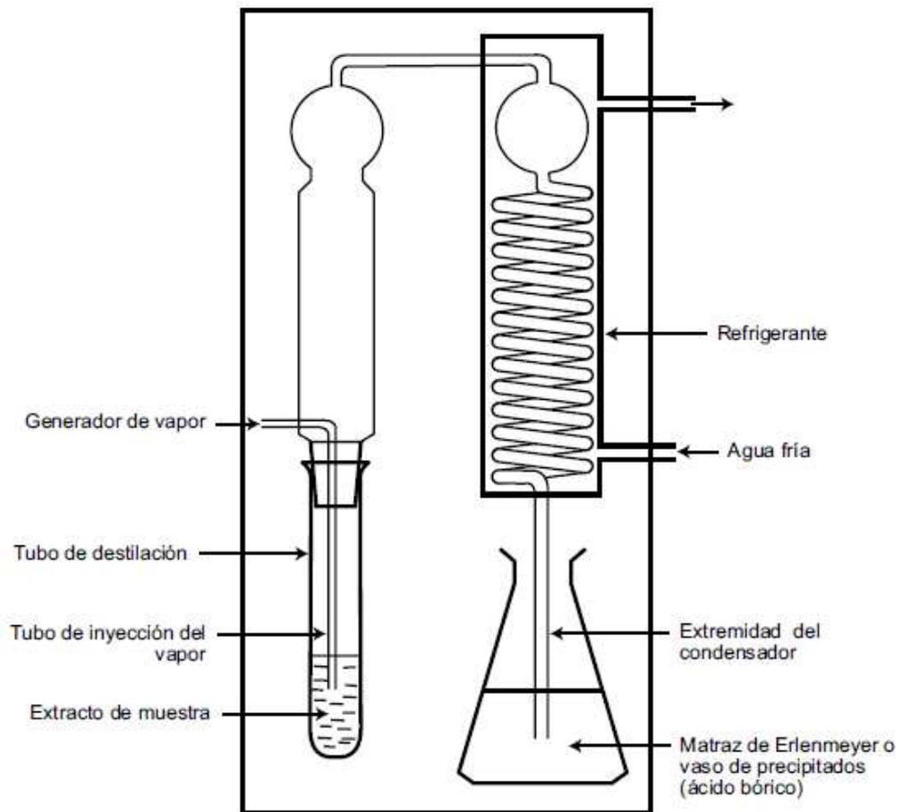
**Figura 1.** Esquema del sistema de destilación por arrastre de vapor [2].
