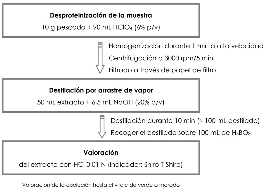
**Figura 2.** Diagrama del procedimiento de análisis del contenido de NBVT en muestras de pescado.
