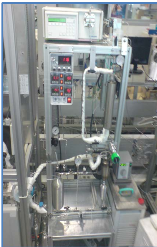
Figura 9. Foto del reactor empleado para el reformado de furfural. Reactor RFL.
