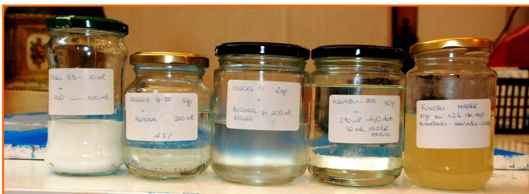
**FIGURA 24. MEZCLAS DE CONSOLIDANTES PREPARADAS PARA LAS PRIMERAS APLICACIONES**
