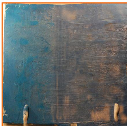
**FIGURAS 25 Y 26. SOLUCIÓN DE ACRIL 33 AL 10% EN AGUA MEDIANTE PAPEL Y PARALOID B-72 EN ACETONA CON AERÓGRAFO RESPECTIVAMENTE.**
