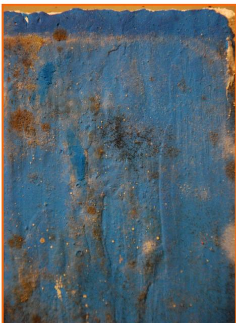
**FIGURA 20. DETALLE DE LA PROBETA CON EL ATAQUE DE MICROORGANISMOS Y EXAGERACIÓN DE LA PATOLOGÍA DE PULVERULENCIA PICTÓRICA**
