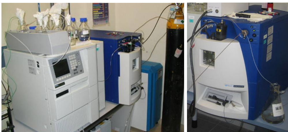
Figura 20. Equipo cromatográfico y detector de espectrometría de masas
