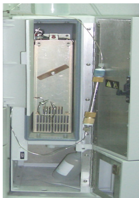
Figura 30. Detalle de la columna C_{18}
