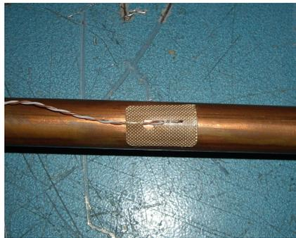
Figura 2. 14. Colocación de termopar en superficie de las tuberías
