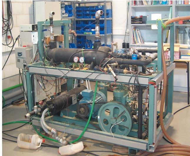
Figura 1. 1. Instalación experimental de compresión en simple etapa [46]
