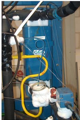
Figura 2. 10. Evaporador de placas y válvula de expansión principal
