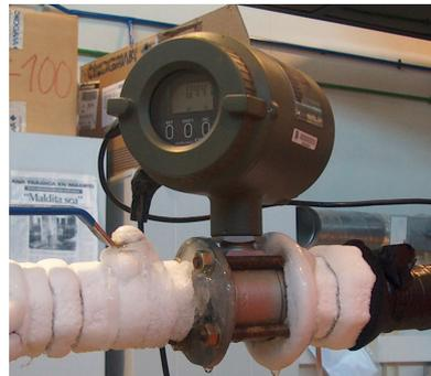
Figura 2. 19. Caudalímetro magnético del circuito del evaporador
