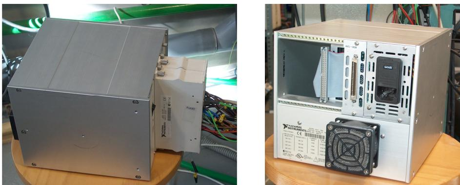
Figura 2. 28. Unidad de adquisición y tratamiento de datos National Instruments. SCXI-1000
