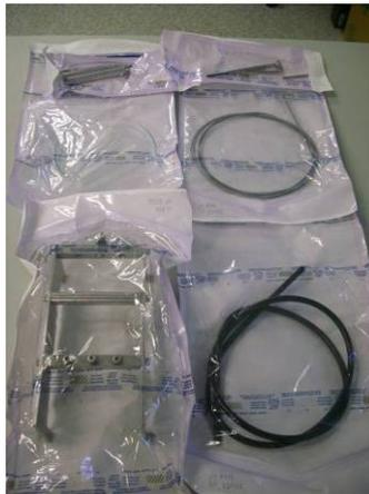
Fig. 2.13 Biorreactor y material de montaje a utilizar en el ensayo antes de proceder al cultivo (carcasa del biorreactor, cable, funda del cable, destornillador, llaves Allen y placa petri).
