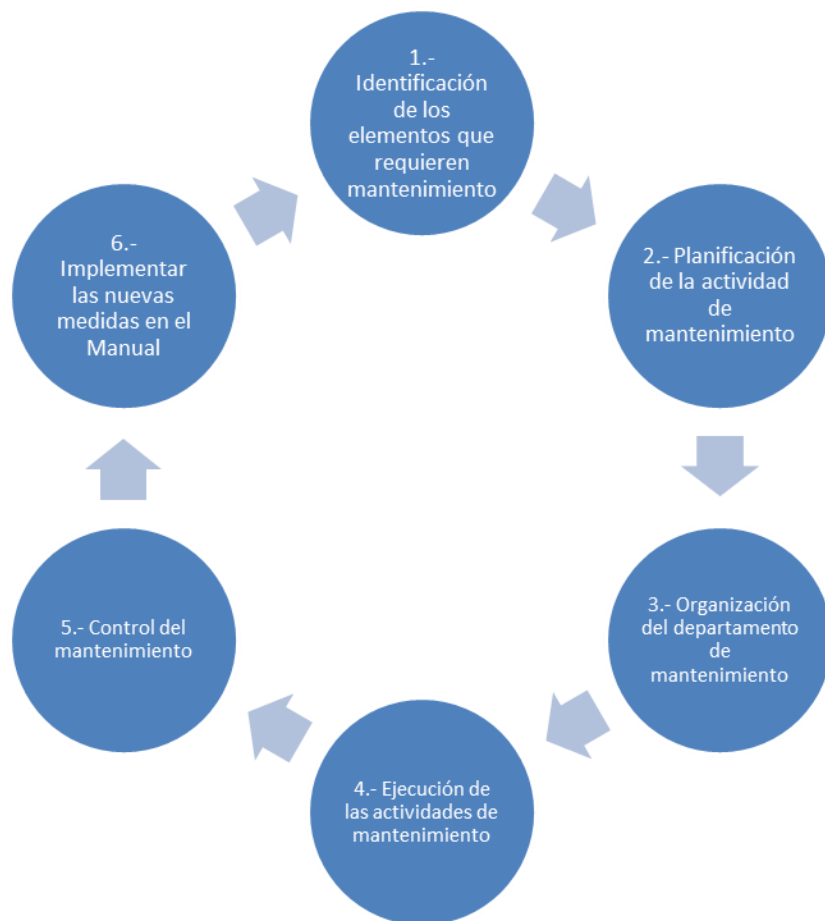
Ilustración 4. 1: Elementos de un manual de mantenimiento
