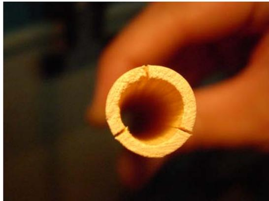
Figura 4.4. Fotografía de uno de los tubos con las tres secciones realizadas por el cuchillo de tres hojas.
