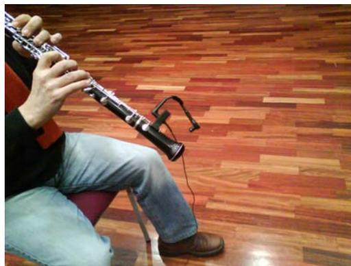
Figura 4.9. Micrófono de proximidad Shure Beta 98H/C usado en la grabación.
