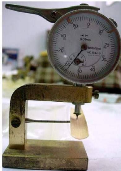
Figura 4.5. Fotografías del proceso de gubiado: pre-gubiado manual (arriba), gubiado con máquina de K. Michael (centro) y medición del gubiado con reloj de K. Michael (abajo)
