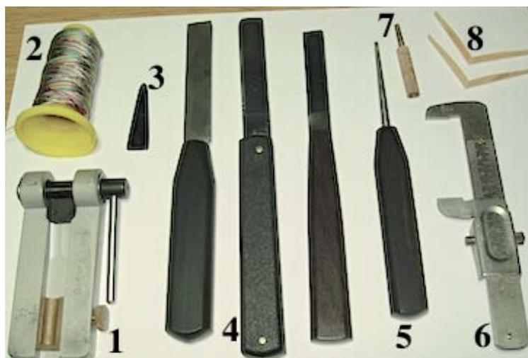
Figura 1.1. Herramientas en la elaboración de las lengüetas. 1: guillotina Rieger; 2: hilo de nailon; 3: espátula de plástico; 4: navajas Chiarugi, Graff plegable y Graff fija; 5: tudelero; 6: pie de rey; 7: tudel; 8: palas.
