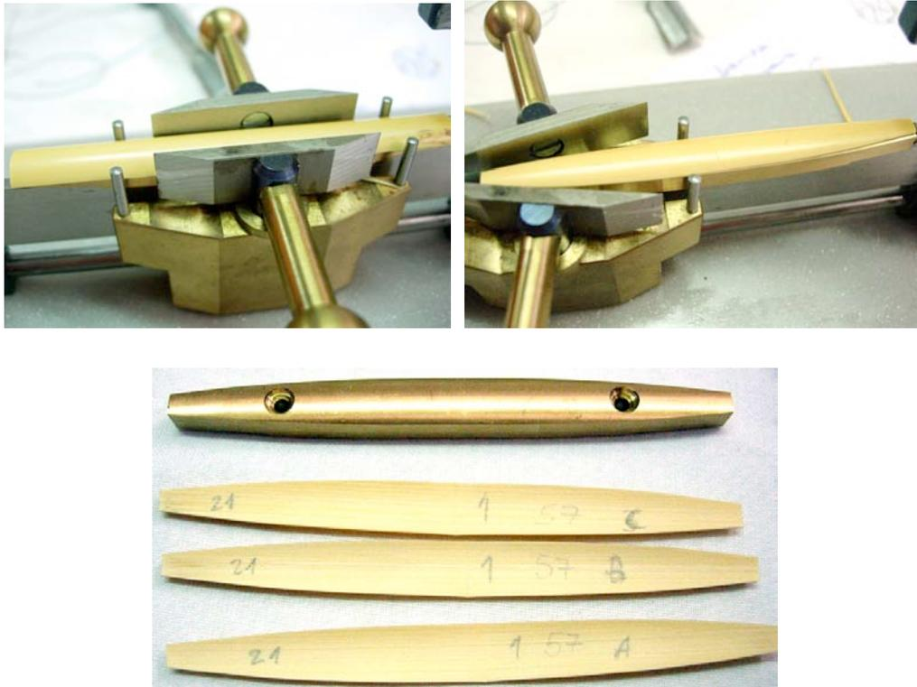
Figura 4.6. Fotografías de la máquina de formas de A. Hörtnagl (arriba) y de uno de los tres moldes utilizados con las tres palas obtenidas (abajo)
