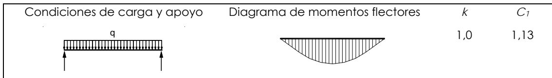
Figura 5. Coeficiente C_1 para soportes biarticulados en los dos planos
