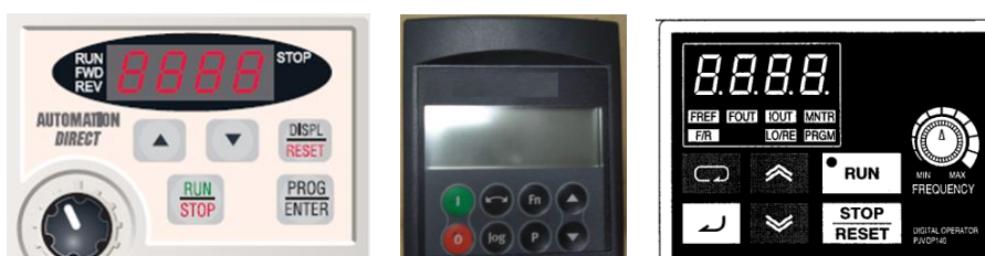
Figura 1. Paneles de control de tres variadores de frecuencia.
