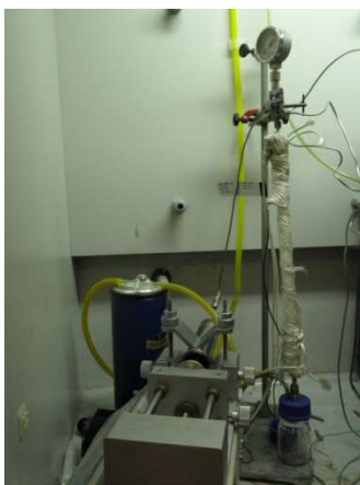
Figura 4.82. Reactor de flujo continuo y lecho fijo en el que se estudió el mecanismo de hidrodesoxigenación del precursor 10a .
