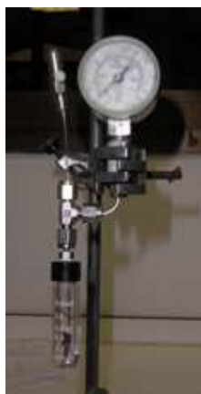
Figura 4.24. Reactor de vidrio de 2 mL donde se llevó a cabo la etapa de hidroxialquilación/alquilación del “Proceso Sylvan” en presencia de ITQ-2 como catalizador.
