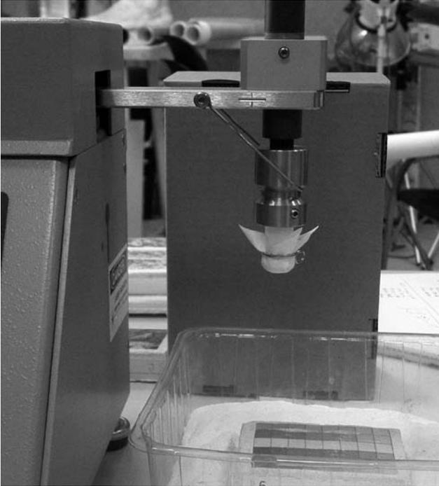
Figura.1. Abrasímetro lineal con el Crock Meter Kit.
