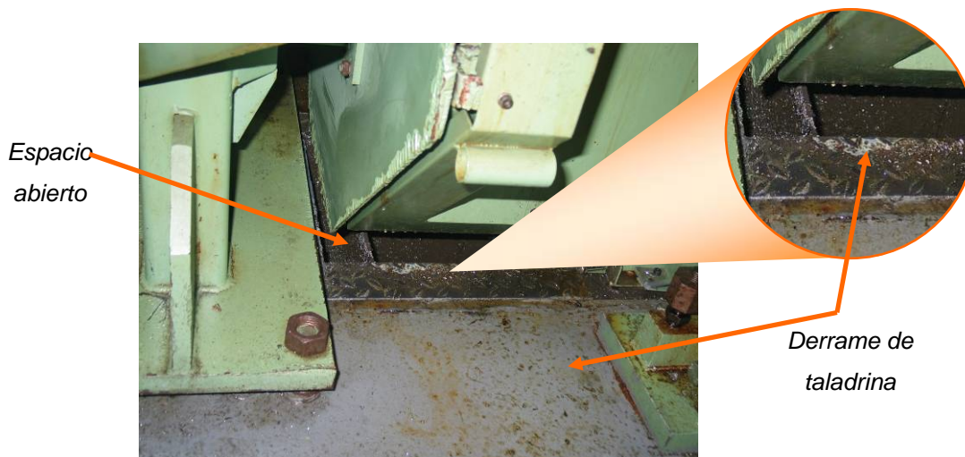
Detalle del espacio abierto entre la transfer y la descarga
