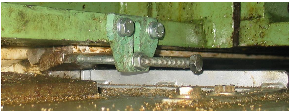
Cuñas de estanqueidad instaladas
