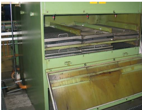
Puertas del frontal y del lateral derecho con juntas deterioradas
