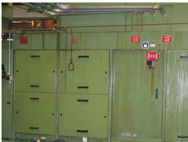
Derrames de taladrina sobre las protecciones de la operación 20
