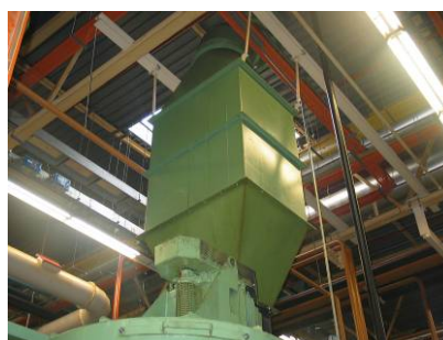
Fugas entre las juntas de la tubería de extracción
