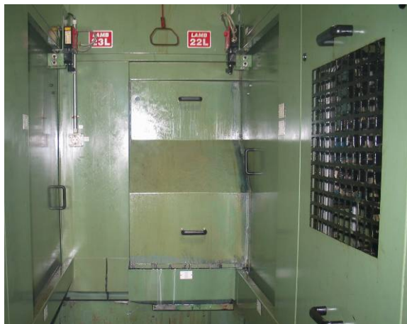
Derrame de taladrina en protecciones móviles
