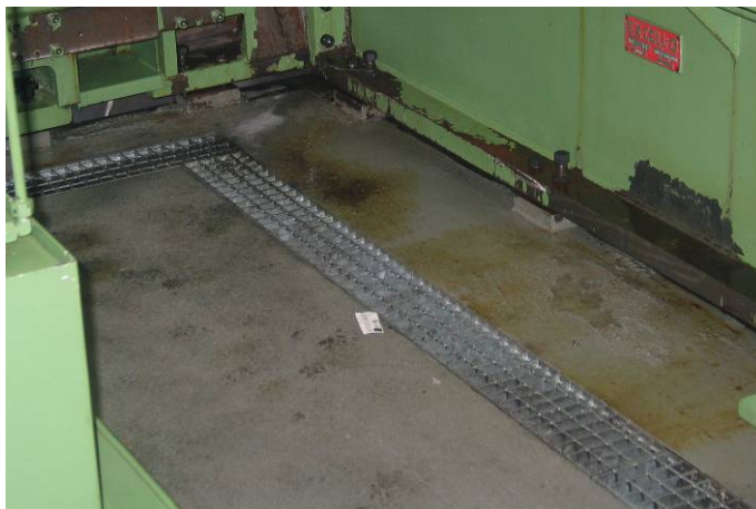
Derrames de taladrina entre el suelo y la bancada en la operación 30
