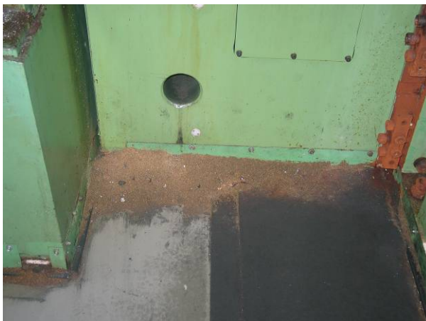
Derrames de taladrina entre el suelo y la bancada en la operación 120
