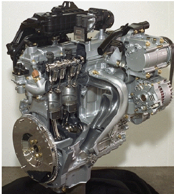
Sección del motor I4
