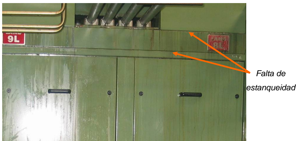
Detalle de la falta de estanqueidad entre los perfiles de la estructura de la máquina
