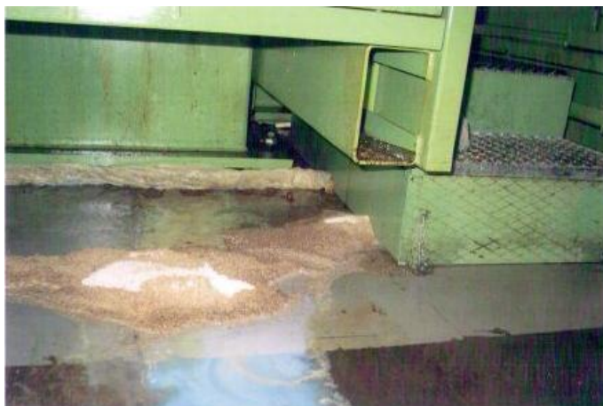
Derrames de taladrina entre el suelo y la bancada en la operación 150A
