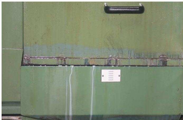
Detalle de un derrame de taladrina en la operación 90
