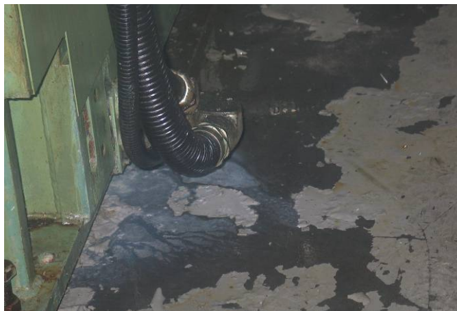
Derrames de taladrina entre el suelo y la bancada en la operación 50
