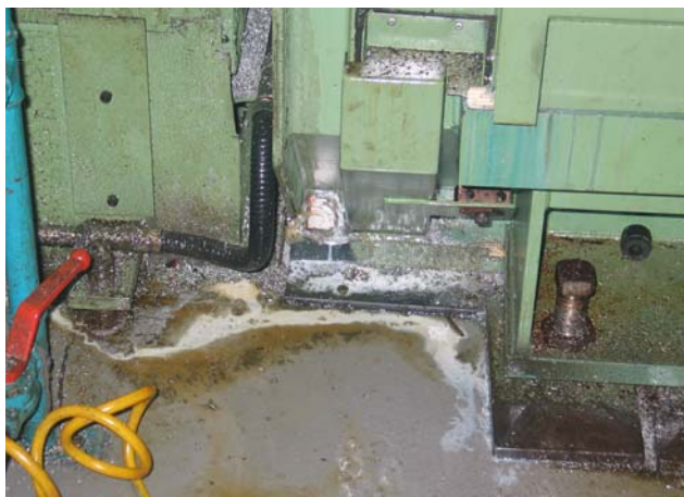
Derrame de taladrina entre la carga y la transfer
