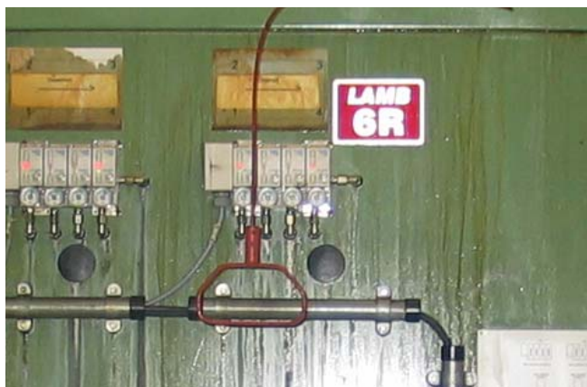
Detalle de los derrames a través de los orificios para tuberías en la estación 6R
