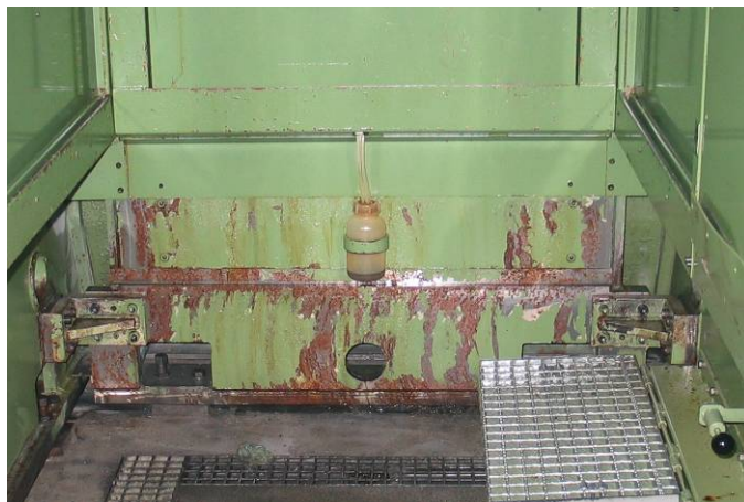
Detalle de las fugas de taladrina en protecciones fijas
