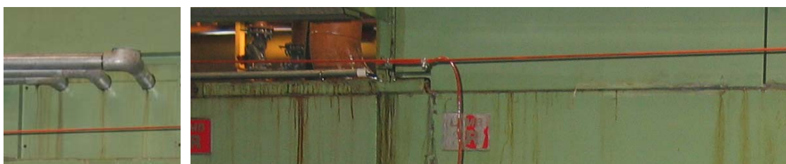
Faltas de estanqueidad en protecciones fijas
