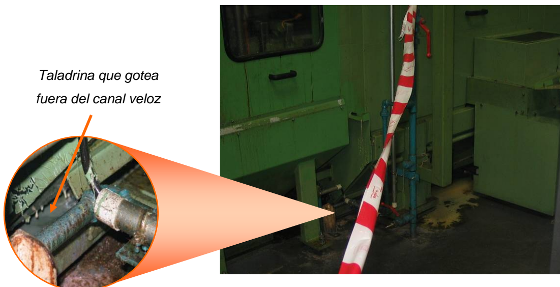
Detalle del derrame en la unión entre la estación de carga y la máquina transfer
