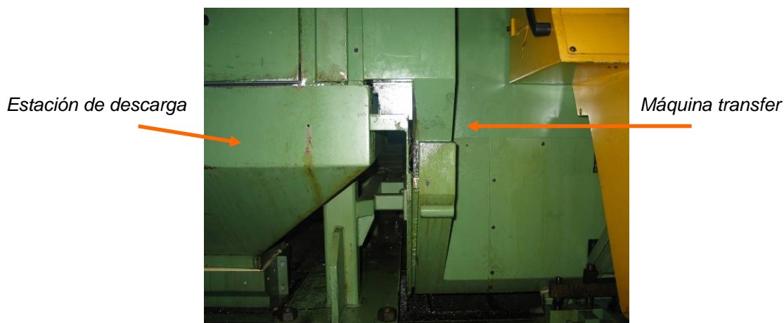
Detalle del derrame en la unión entre la estación de descarga y la máquina transfer
