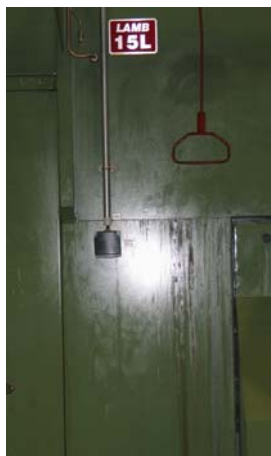
Falta de estanqueidad entre protecciones fijas a tope
