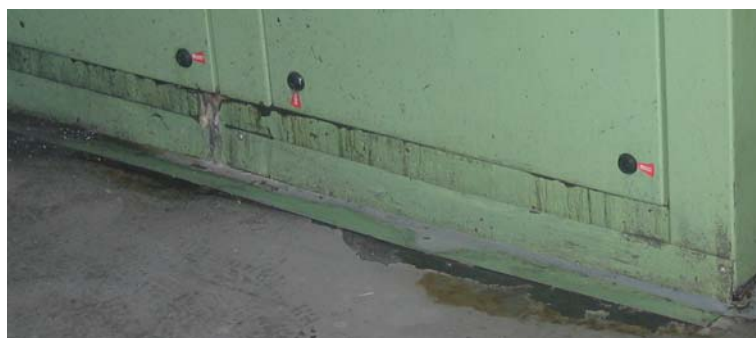
Derrame de taladrina por la parte baja de las puertas desmontables
