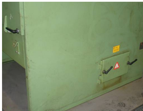
Puertas del frontal y del lateral derecho con juntas deterioradas
