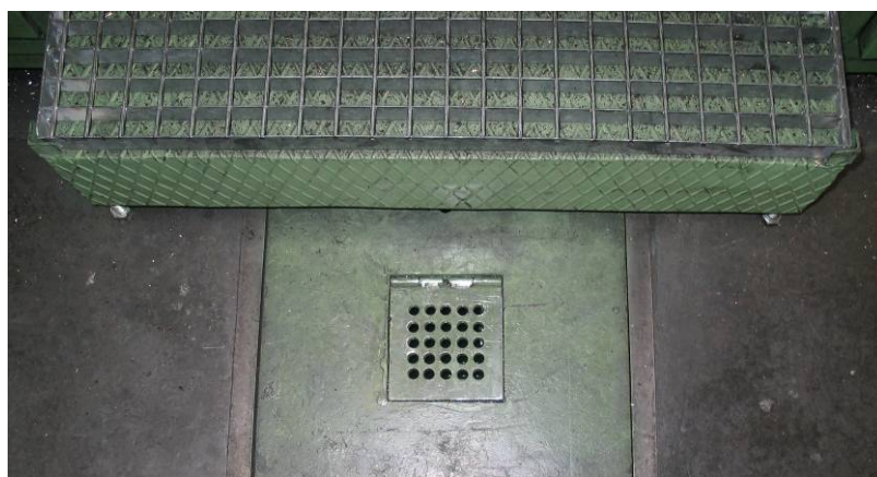
Tapa de registro para controlar el nivel de aceite y poder vaciar el depósito con una aspiradora
