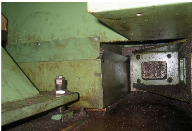
Parte inferior derecha de la máquina vista desde el exterior. Derrame de taladrina y viruta
