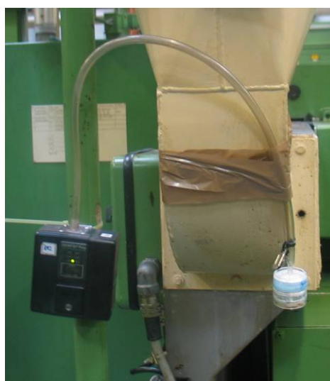
Medición estática de la concentración de vahos en el ambiente.
