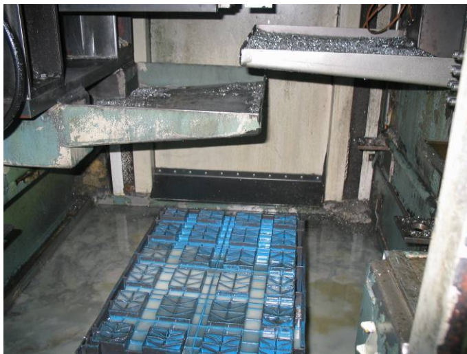
Interior de la estación de unión. Se aprecia la bandeja sellada a los laterales y el deflector instalado en la puerta
