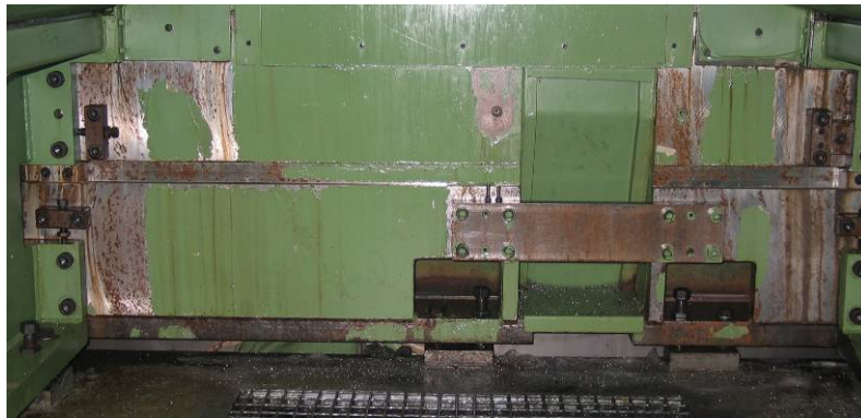
Detalle de las fugas en protecciones fijas
