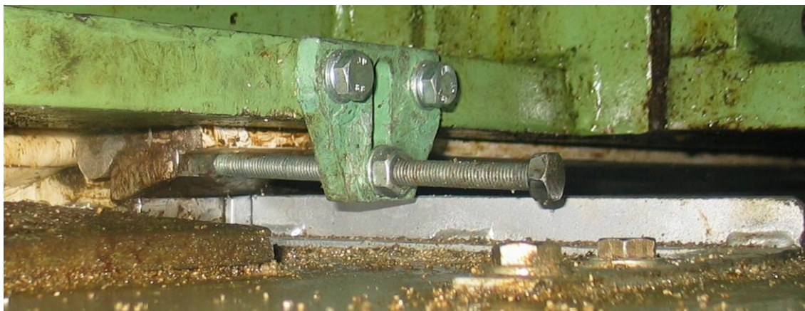
Cuñas de estanqueidad instaladas
