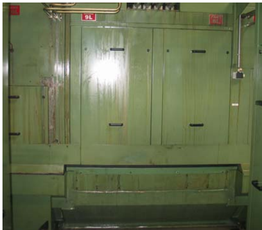
Derrames de taladrina sobre las protecciones de la operación 100
