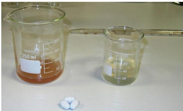
Figura 3.20. Vaso de precipitados de 250 ml con el mosto recién prensado, vaso de precipitados de 100 ml con 5 ml de mosto y 35 ml de agua destilada, pipeta e imanes.
