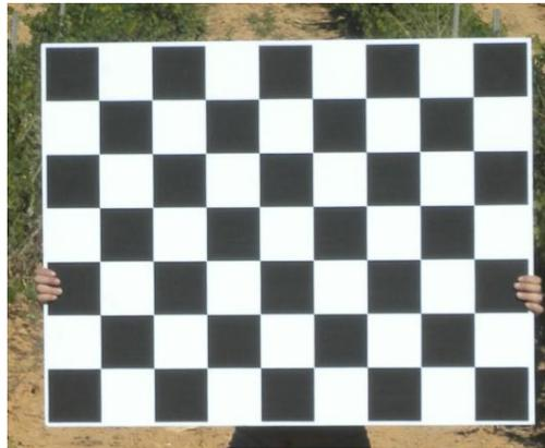
Figura 3.8. Panel de calibración para estimar equivalencia píxel-cm.
