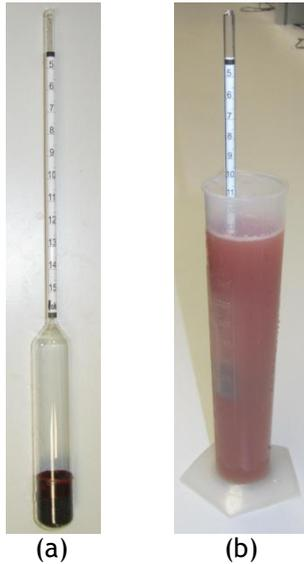
Figura 2.21. Areómetro Baumé (a) y su aplicación a una muestra de mosto (b).
