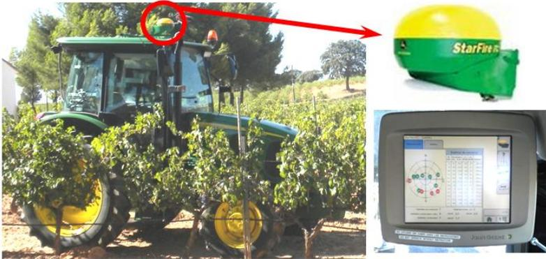
Figura 2.7. Tractor utilizado en las pruebas de campo: detalle de la antena del receptor GPS y pantalla de control e información (GreenStar™).
