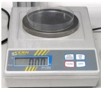
Figura 2.18. Balanza de precisión KERN 440-33.
