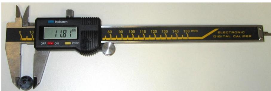
Figura 2.19. Calibre digital midiendo el diámetro de un grano de uva.
