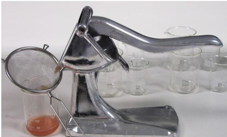
Figura 2.17. Prensa manual utilizada para la extracción del mosto.
