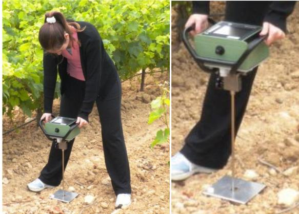
Figura 2.9. Penetrómetro para estimar la compactación del suelo.
