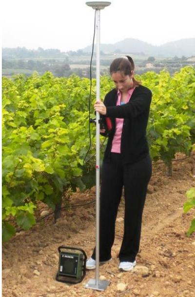
Figura 2.10. Adquisición de coordenadas globales para mapas de compactación de suelos en viñedos muestreados.
