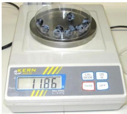
Figura 3.21. Obtención del peso de una muestra de 10 bayas.
