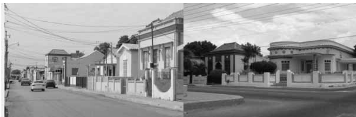
Vivienda colonial evoluciona y se adapta a las Ordenanzas de sobre Arquitectura y Ornato Público (Año 1927) dejando retiros de frente y en algunas oportunidades pequeños retiros laterales.
