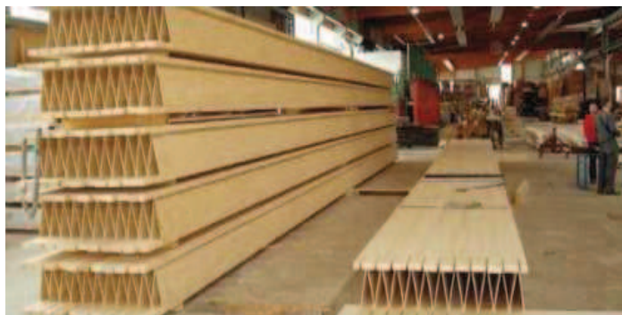
Imagen 5.2.2.a. Paneles Kielsteg en fabricación.
