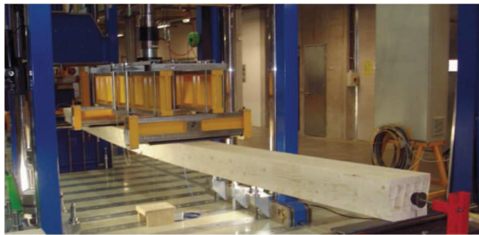
Imagen 5.2.2.c. Prueba de resistencia a la que se someten los paneles.
