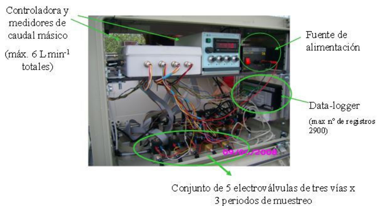
Figura 16. Sistema automuestreador desarrollado: a) imagen exterior, b) imagen interior.
