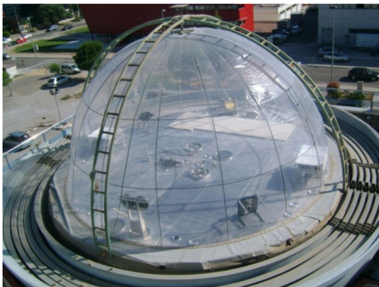
Figura 14. Imagen de una las cámaras de simulación EUPHORE durante un experimento de foto-oxidación.
