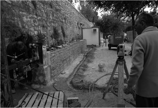
Imagen 1 Muro de calibración durante el primer taladro y equipo topográfico.
