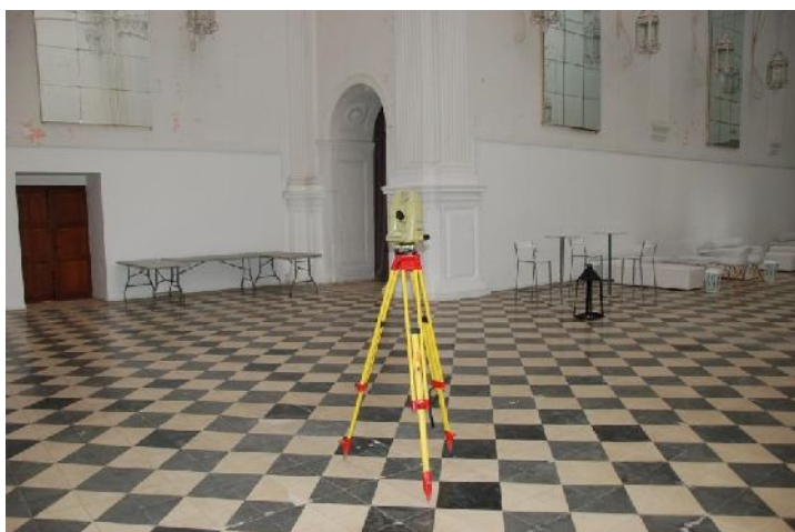
Estación total utilizada en el levantamiento de planos.
