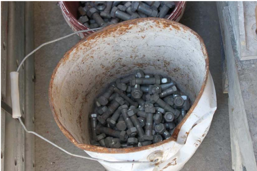
Tornillos de alta resistencia que permiten la unión del mecano (Fotografía 7)
