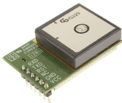
1. Funcionamiento mediante el protocolo NMEA.
