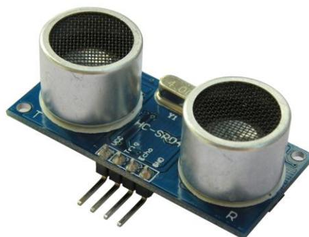
Tiene un alcance que va desde los 2 cm hasta los 4 m. Su funcionamiento no se ve afectado por la luz ni por ninguna superficie negra (algunos sensores de proximidad se
