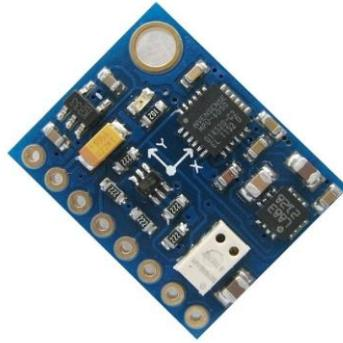
Para el intercambio de datos, sigue un protocolo de maestro/esclavo, en la cual cada uno de los “participantes” puede acceder al bus cuando las líneas SDA y SCL se encuentran en estado lógico alto, y se comunican entre ellos mediante pulsos de reloj y el envío y recepción de ACKs.
